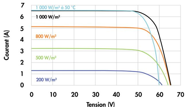
Caractéristiques de courant/tension en fonction de l'ensoleillement et de la température du module.
